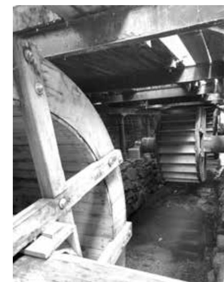
VODNÍ SOUKOLÍ POD VANTROKY POHÁNĚJÍCÍ HAMERNICKÁ ZAŘÍZENÍ
